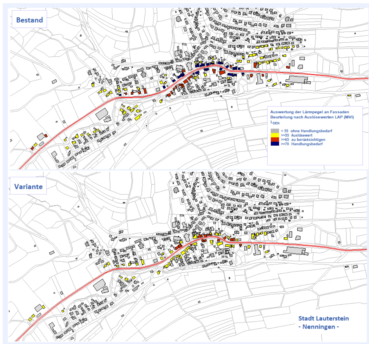
Abb.: GLK Stadtteil Nenningen: Pegel an Gebäudefassaden -> Vergleich zwischen Bestand 2014-2015 und DTV halbiert / SV-Anteil 1,5 %
